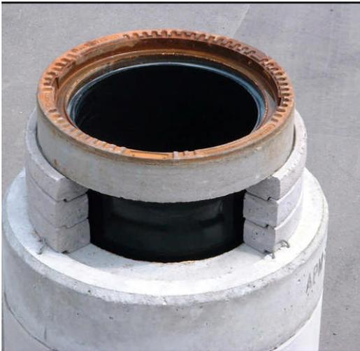
*Abdichtung durch Verpressung von zwei NBR-Elastomerdichtungen im Ringspalt zwischen dem Schachtaufbau und einem eingepressten PE-Dichtring.*
